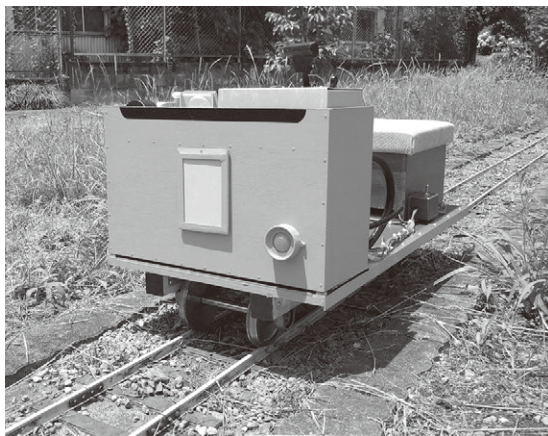
写真1 実車同様のモータ駆動音を鳴らす車両を製作した
