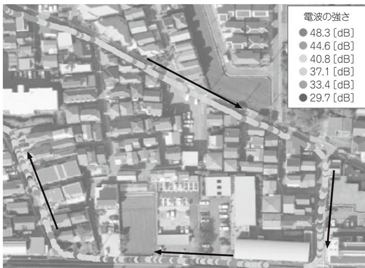
図1 住宅地の周りを移動しつつ測定した電波強度を地図に描く
