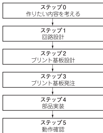
図1 プリント基板を製造して実装するまでの流れ プリント基板製造サービスの進化により個人でも簡単に 製造できるようになった
