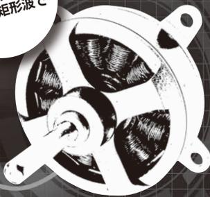
第10回 ホール・センサなし…ロータ位置合わせ/同期駆動/センサレス駆動
