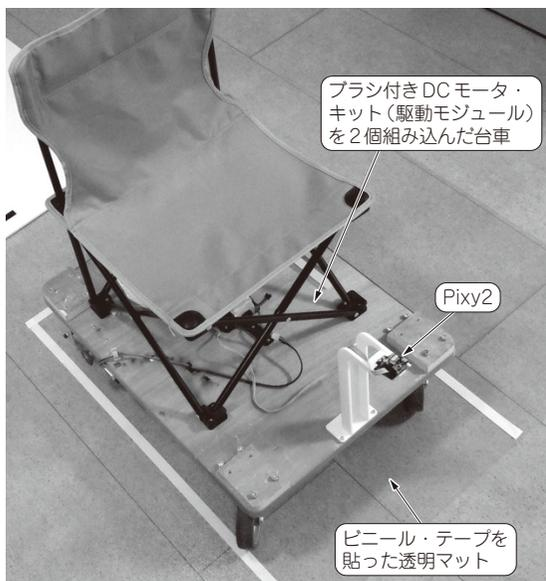
写真1 自動駐車の実験に使う電動台車と駐車区画
