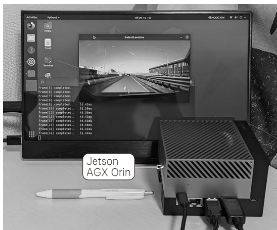
写真1 自動運転向けアプリケーションが動作している動画像に対して自分の車が走っているレーン領域を抽出する
