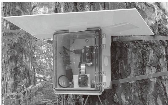
写真1 東京大学 富士癒しの森研究所 演習林に設置したカメラ・システム
