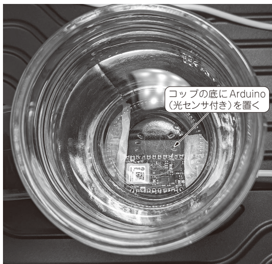
写真1 コップの底に Arduino を置いてルイボスティーの色を検出する
