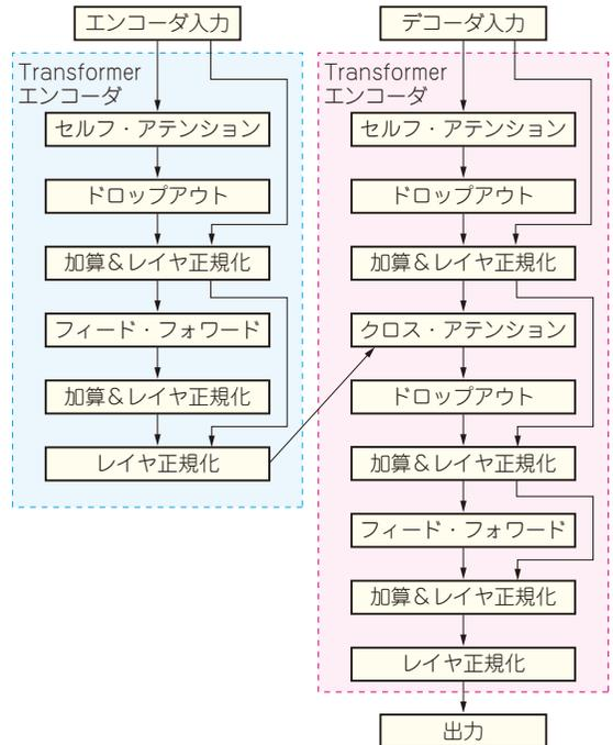
図1 PyTorch実装のTransformersモデルをtorchview<sup>(2)</sup>によって可視化し加工したネットワーク図
