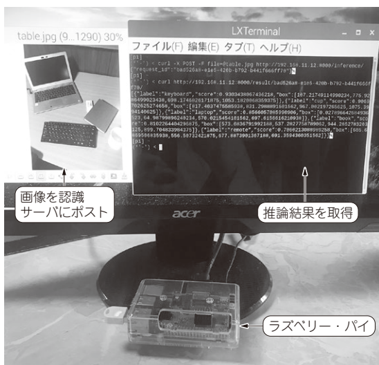
図1 ラズベリー・パイから認識サーバにアクセスしている様子
