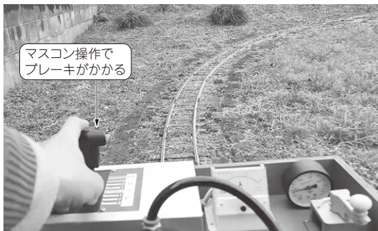
写真1 筆者の製作した小型電車に実車同様のブレーキ・システムを搭載しブレーキ性能をテスト
