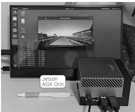
写真1 Jetson AGX Orinで高速道路の白線を認識中
