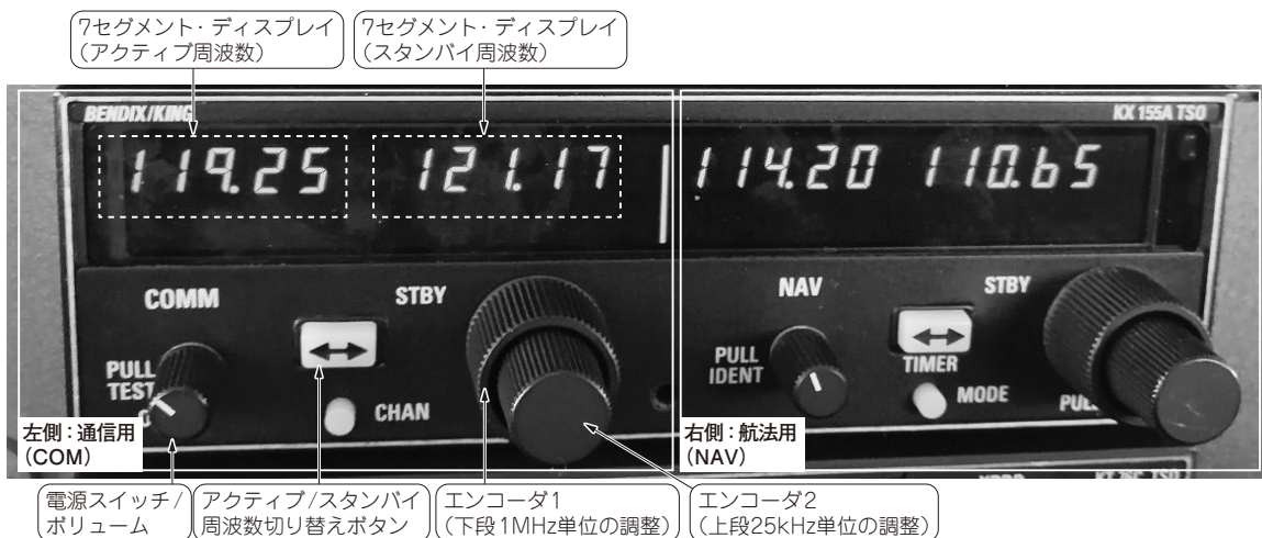
写真1 実際に航空機に搭載されている無線機
