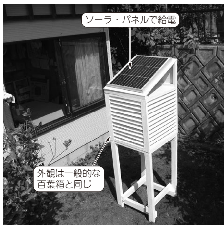
写真1 製作した電子百葉箱をカボス畑に設置した畑でなくても庭に百葉箱を置いておくだけで自然が身近になる
