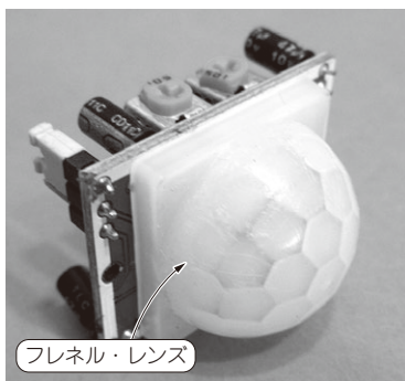
写真1 焦電センサ HC-SR501
