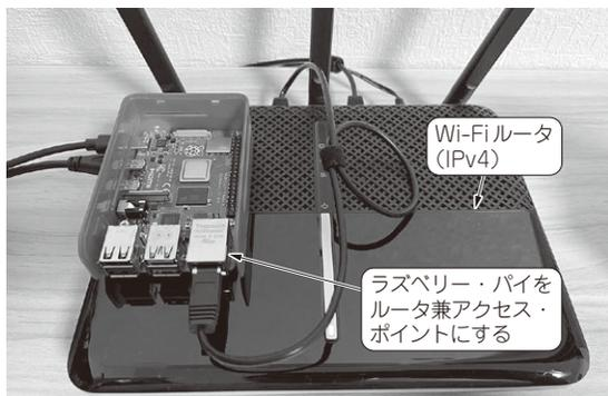
写真1 本稿でやること…「NAT64/DNS64」を用いてIPv4と相互通信可能なIPv6-onlyネットワークを構築する
