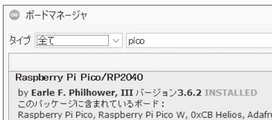
図1 PicoをArduino開発環境で使用するためのパッケージボードマネージャから、Raspberry Pi Pico/ RP2040をインストール
