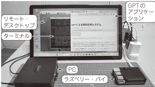
写真1 Dockerを利用してラズベリー・パイ上にGPT質問応答システムを構築した
