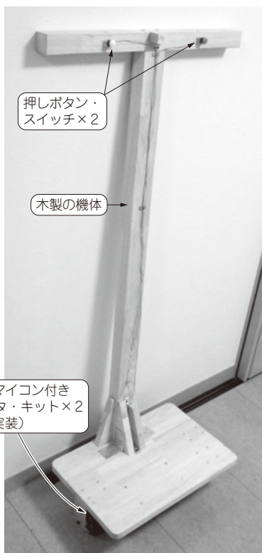
写真1 スイッチ操作で任意の方向へ曲がれるようにする
