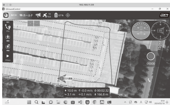
図2 箱庭ドローン・シミュレータを実行しているシーン(QGC)
