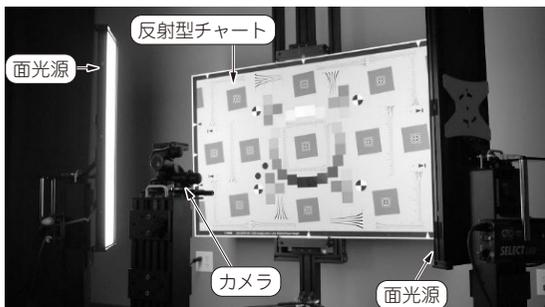
写真1 反射型チャート・システム
