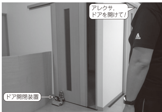
写真1 本稿で製作するドア開閉装置を筆者宅のドアに設置した様子
