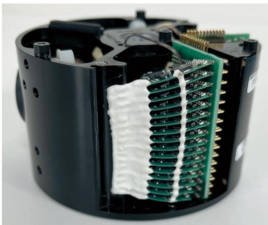
写真1 かつて3D LiDARが高価だった理由…レーザと受光素子が実装された基板を1つ1つアライメントを取りながら積層していたから
