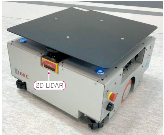
(b) 2D LiDARとしてSE2L (IDEC) 搭載
