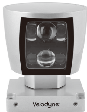
写真2 水平視野角360°、垂直視野 角26.9°、測定距離120mの HDL-64E (Velodyne Lidar, 現Ouster) 昔からある機種でソフトウェア やサンプル・データが豊富
