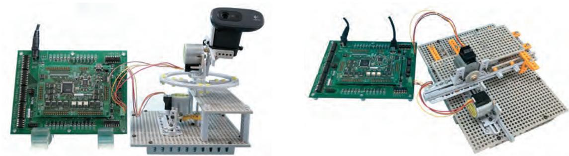
(a) カメラのパン、チルト機構
