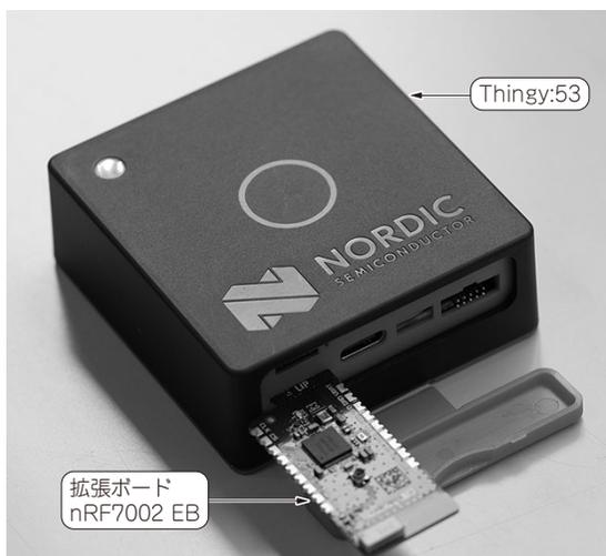
写真1 Matter通信もできるIoT試作プラットフォーム Thingy:53
