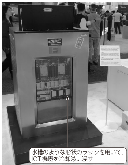
写真2 GPUサーバの冷却方法②…液浸ラック デモ用で水槽のような形状をしている
