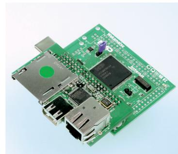
写真4 LAN & SD カード・ソケット拡張基板と付属 ARM マイコン基板の組み合わせ
