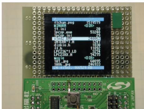
写真1 付属ARMマイコン基板を使ったオリジナル・モバイル端末
