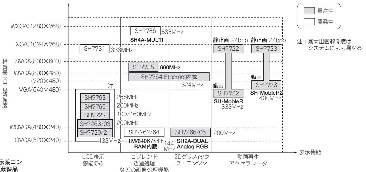
図 1 SuperH 表示系コントローラ内蔵製品
