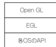
図1 EGLは、各OSのOpenGL向けAPIの差異を吸収する
