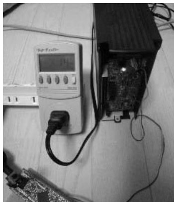
写真 1 KURO-BOX/PRO の消費電力を測定 (約 14W)
