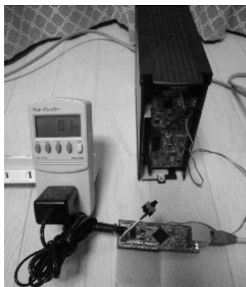
写真 2 ColdFire マイコン基板の消費電力を測定 (約 1W)
