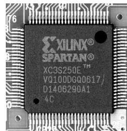
▶ 図2 Xilinx 社 FPGA の外観例
