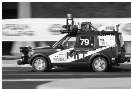
写真1 コースを疾走するMITチームの車 Land Rover 3 各種センサからのデータにより、無人で自律走行している。
