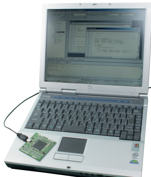
写真 2 USB ケーブル 1 本で実機デバッグ可能
