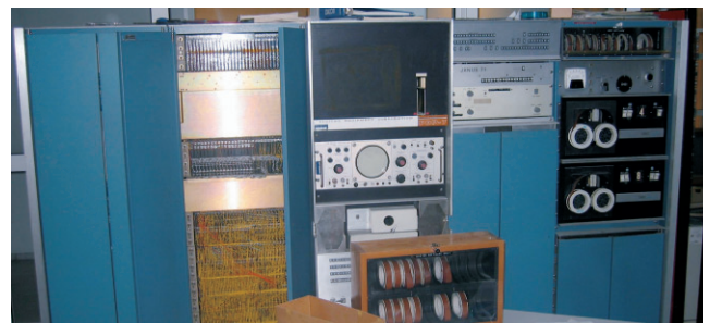
▶ 写真2 米国 Digital Equipment Corporation が開発したミニコンピュータ「PDP-7」(Wikipedia より引用) (3)
