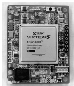
写真1 Virtex-5 を搭載した小型 FPGA 評価ボード XCM-107
