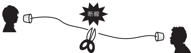
図1 タイムアウト処理を行わないと、いつまでも断線に気づかない
