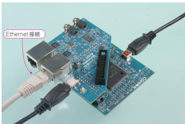
写真1 FM3マイコン基板対応拡張ボードでネットワーク通信
