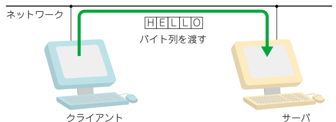
図2 TCP/IPのルールに従ってクライアントとサーバの間でバイト列を送受信する
