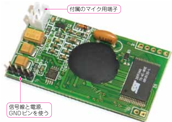
写真2 音声認識を手軽に実験できるモジュール「SR-MOD100」 マイクロテクニカ ( http://microtechnica.net/ ) から5,250円で購入できる
