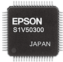
写真1 単語認識機能と音声合成機能(50語)を搭載するS1V50300(セイコーエプソン)を 法人向けICなので個人では入手しにくい
