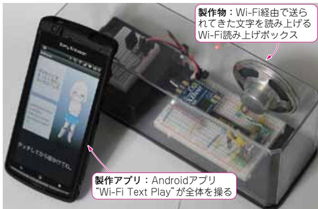
写真1 定番無線モジュールのWi-Fi版であるXBee Wi-Fiとスマホを使ったネットワーク音声認識&読み上げ装置
