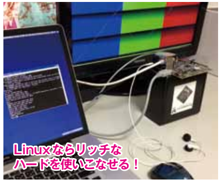
写真6 スマホ用オールインワンのデュアル・コアSoCを簡単に楽しめる「PandaBoard」
