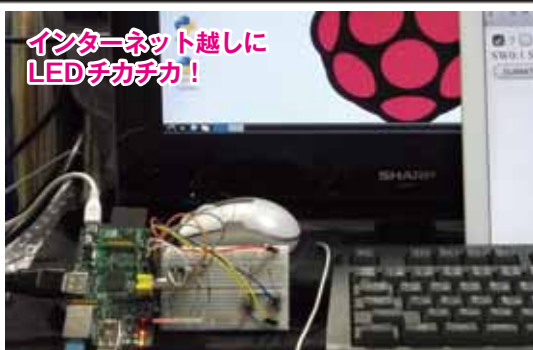
写真2 iPadを使ってRaspberry PiボードのI/OをEthernet経由で操作
