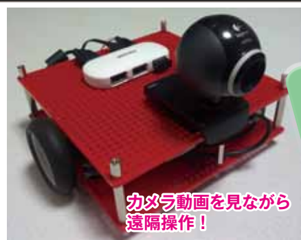
写真3 搭載されているカメラの動画をリアルタイムに見ながら操縦できるRaspberry Piボード・ラジコン
