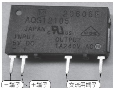
写真1 マイコンが出力する0/5Vの信号で、100V<sub>RMS</sub> (141V<sub>P-P</sub>)の交流電圧をON/OFF制御できる半導体リレー AQQ12105 (パナソニック)
