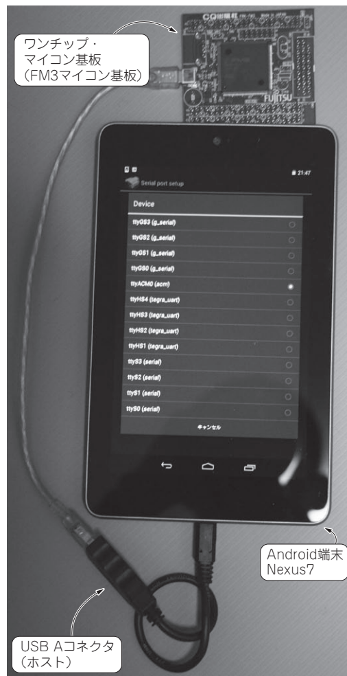
写真1 Androidタブレットとワンチップ・マイコンの仮想シリアル通信にトライ
