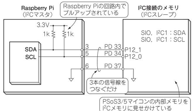
図1 今回の実験…Raspberry PiとI<sup>2</sup>Cメモリを接続してライト/リードの動作を確認する
