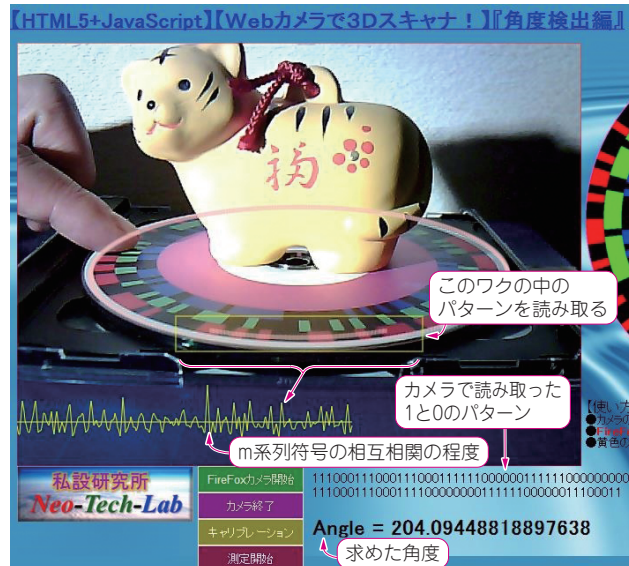
図2 カメラで撮影したパターンを画像処理すれば回転角度を特定できる
