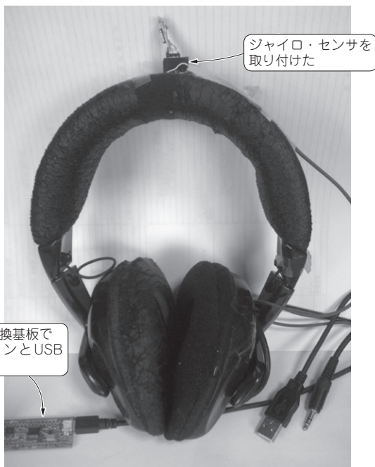
写真1 製作したヘッドホンは音が立体的に聞こえるどっちを向いても音源の位置が動かない…ようにマイコン(dsPIC)で演算する
