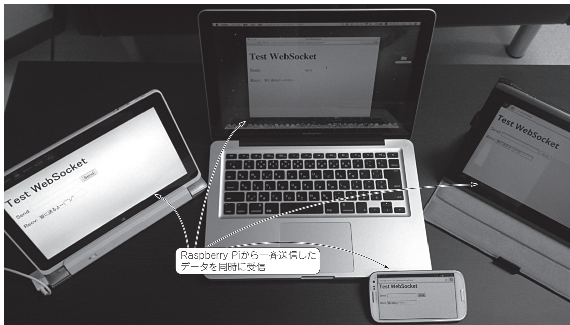
写真1 HTML5の通信機能WebSocketで複数のWebブラウザを同時に更新できた 大規模なチャットや同報通信システムにも利用できる
